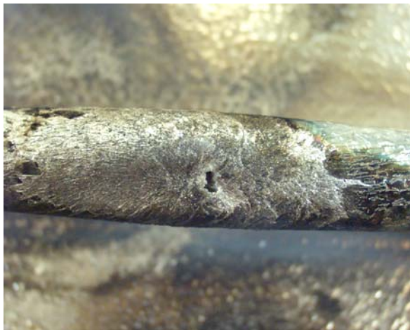
Bild 2.3a: Resultat eines Grenzversuchs mit 200 kA 10/350 an einem gebördelten beschichteten Blech mit einer Blechdicke von 0,7 mm im BET. Perforation: 2x4mm (Kal-Zip).
