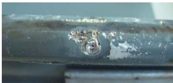
Bild 2.5b: Ansicht des Bleches unterhalb der Klemme im obigen Bild nach 3 Stößen zu je 100 kA, 50As/2,5 MA 2 s; 10/350.
