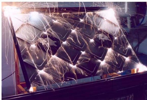
Bild 1.4a: Prüfung eines Dachmusters mit 100kA 10/350 Stoßstrom, hier der dritte Stoß. Einspeisung Oben links. Auskopplung unten links und rechts.
